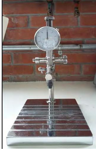
**Figura 8:** Penetrómetro manual
