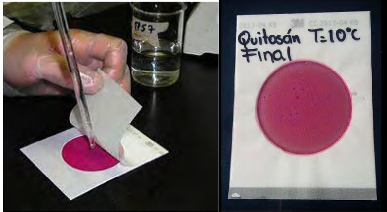
**Figura 12:** Determinación de Coliformes totales en placas 3M Petrifilm
