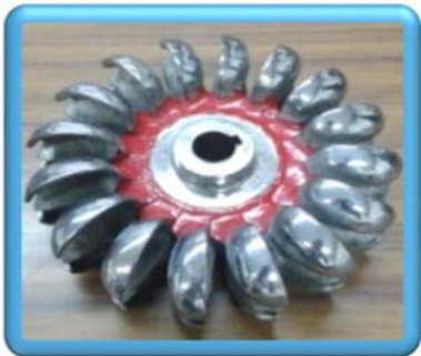
Figura 19.- Rueda Pelton constituida por 16 alabes en forma de doble cuchara.
