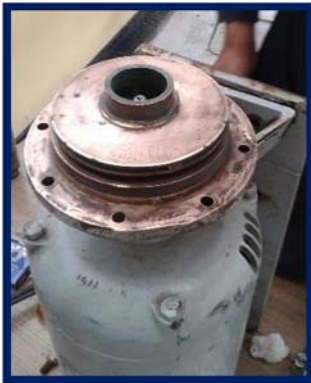
Figura 42: Colocación de la bomba y sus elementos internos.
