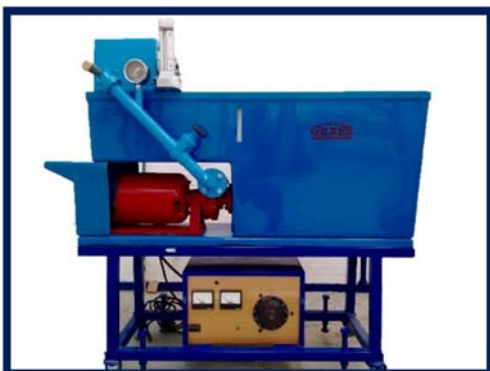
Figura 48: Elemento denominado turbina Pelton rehabilitada por completo.
