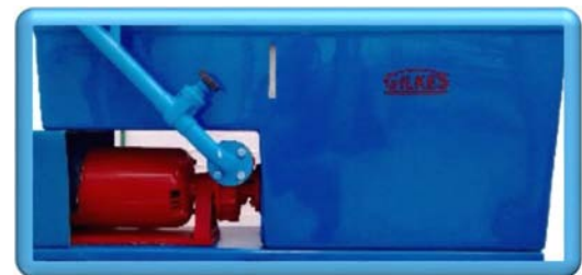
Figura 20.- El depósito es de fibra de vidrio y su mayor volumen se concentra en el tanque derecho.
