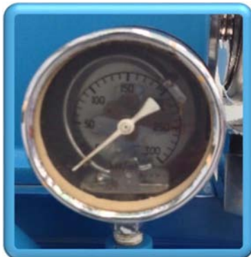
Figura 17.- Manómetro con escala de 0 a 300 KN/m^2
