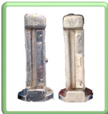
Figura 11.- Dinamómetros con escalas en Newton y en pounds.
