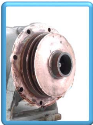
Figura 13.- Bomba centrífuga impulsor cerrado.
