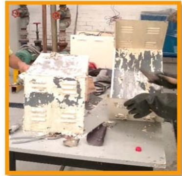
Figura 31: Aplicación del removedor de pintura.
