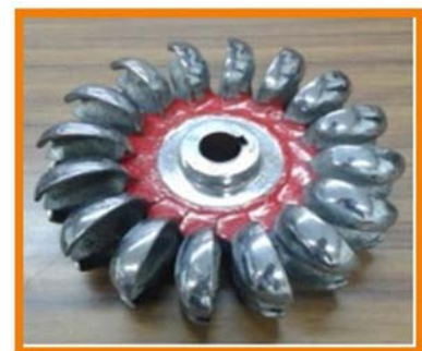
Figura 45: Rueda Pelton rehabilitada.
