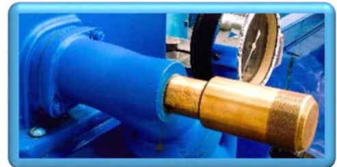
Figura 16.- Válvula de aguja de la turbina Pelton.
