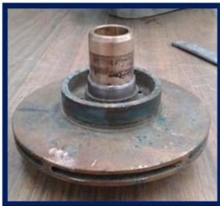
Figura 28: Deterioro del Impulsor inicialmente.
