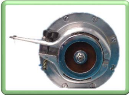
Figura 12.- Freno Proney colocado en el rodete su nombre se debe a su inventor Gasparé de Proney.
