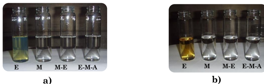
Figura 16. Prueba de Shinoda para los compuestos extraídos con diferentes solventes. a) Colores antes de la reacción de Shinoda. b) Resultados obtenidos después de la reacción de Shinoda.
