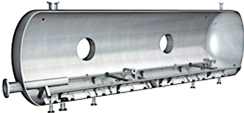
Figura 4.4 Sistema de remoción de arenas. [2]
