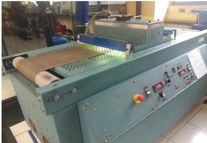
*Figura 2.5. Equipo empleado en el proceso de curado.*
