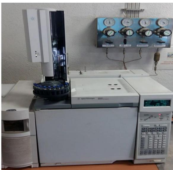
**Figura B.2.** Cromatógrafo Agilent 6890 Thermo Scientific
