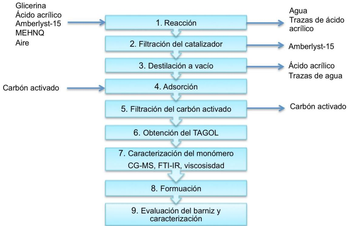
**Figura 3.2.** Procedimiento experimental.
