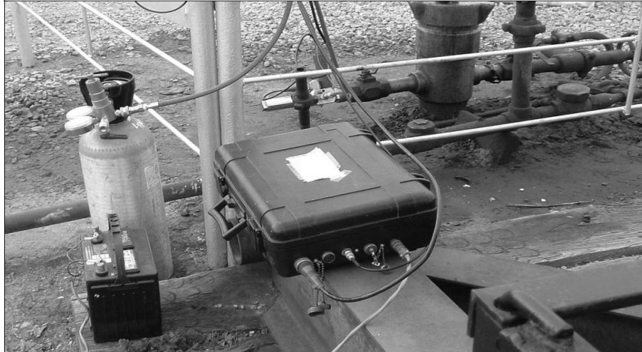
Fig. 1.4. Diagrama que ilustra los diversos componentes del sistema digital acústico (Fuente: Best Practices for Pressure Transient Tests Using Surface Based Measurements).
