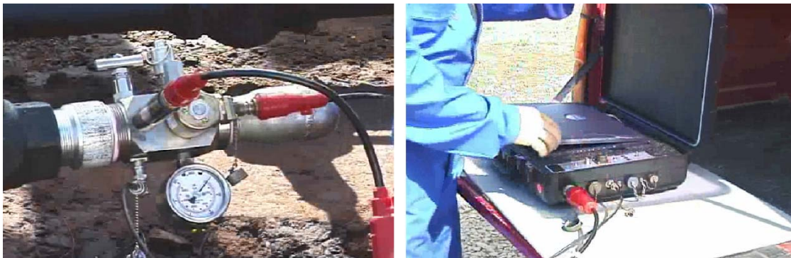
Fig. 2.4. Conexión entre Pistola de Gas y Analizador (Fuente: UPCO Consultores Ecómetro S.A.)
