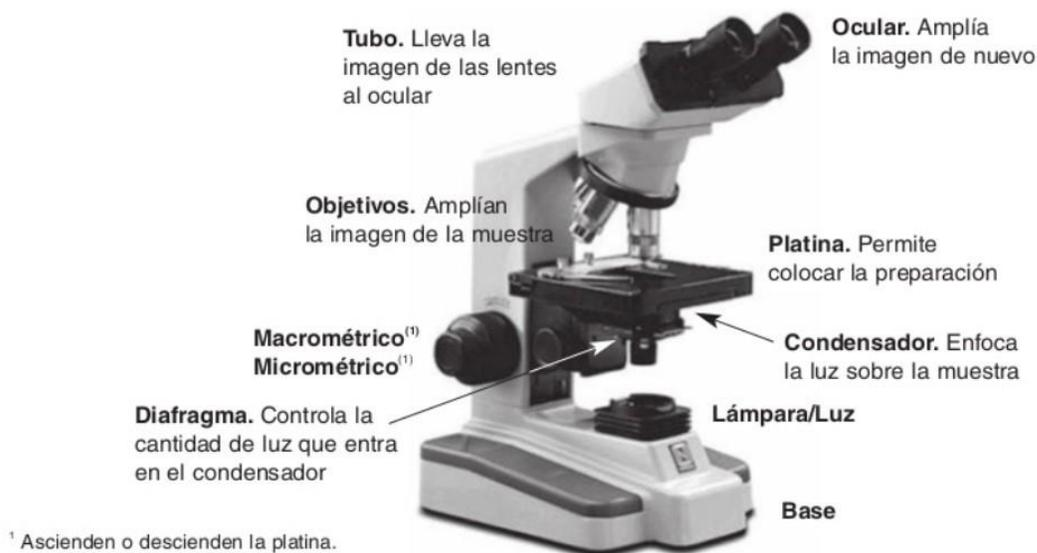
Figura 9. Microscopio óptico compuesto de fondo claro. Tomado de: Liébana, 2002.
