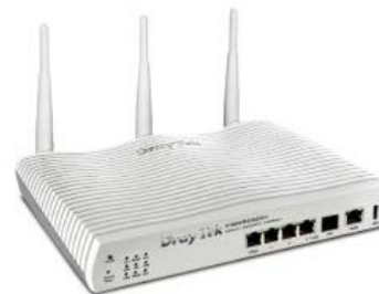
Imagen 111.- Router WAN ADSL/VPN/VoIP/MODEM xDSL CON FIREWALL & DDNS
