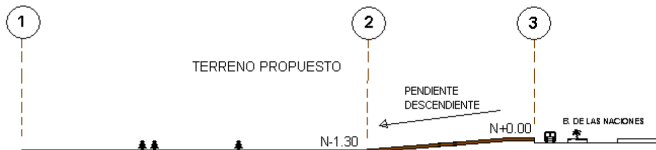
Imagen 86.- Corte topográfico del terreno
