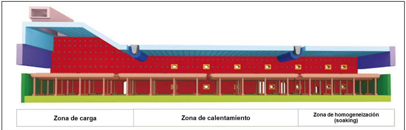
**Figura 14. Diagrama del horno de recalentado; cuenta con tres zonas para garantizar material homogéneo. (9)**
