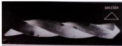
Fig. 29 Representación de la sección triangular de un escariador [24]. Endodoncia: Técnica y fundamentos.
