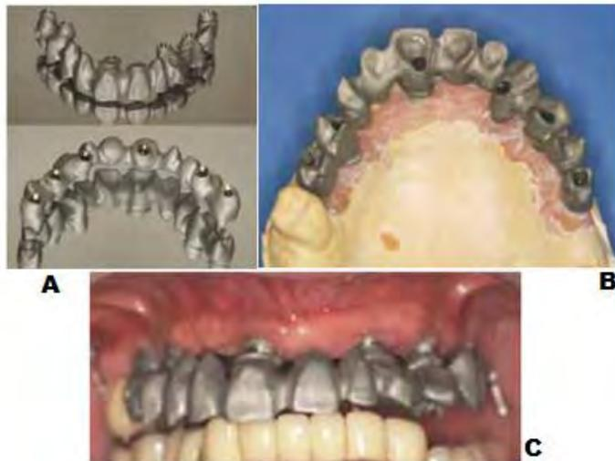
Figura 11 A) Estructura en Co-Cr sinterizada por Láser. B) Estructura en el modelo maestro. C) Prueba clínica de la estructura.
