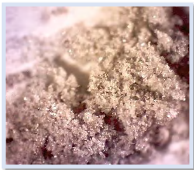
Figura 20. Polvo de escoria. Pan del cribado, tomada a 40x.
