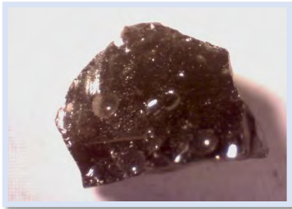
Figura 12. Partícula de escoria. Malla 14, tomada a 12x.
