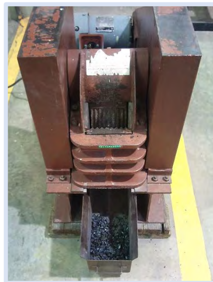
Figura 5. Trituración de escoria en trituradora de mandíbula.
