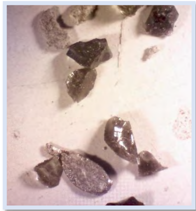
Figura 16. Partículas de escoria. Malla 40, tomada a 12x.
