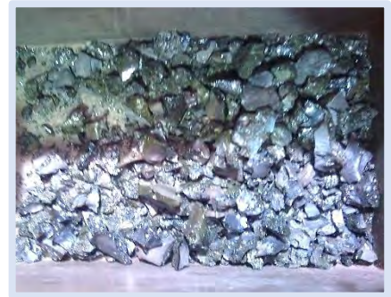
Figura 6. Escoria después de trituración.
