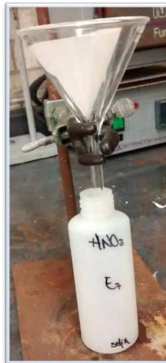
Figura 10. Filtrado de la solución.
