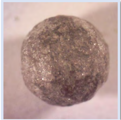
Figura 15. Partícula metálica. Malla 14, tomada a 15x.
