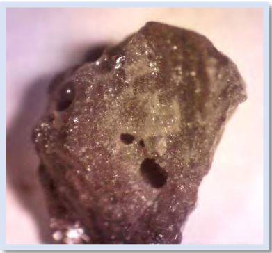
Figura 19. Partícula de escoria. Malla 30, tomada a 25x.
