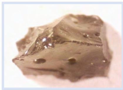
Figura 14. Partícula de escoria. Malla 14, tomada a 12x.
