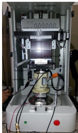
Figura 32 Montaje experimental final con el tribómetro
