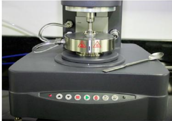
Figura 3.3. Reómetro de esfuerzos controlados ARG-2
