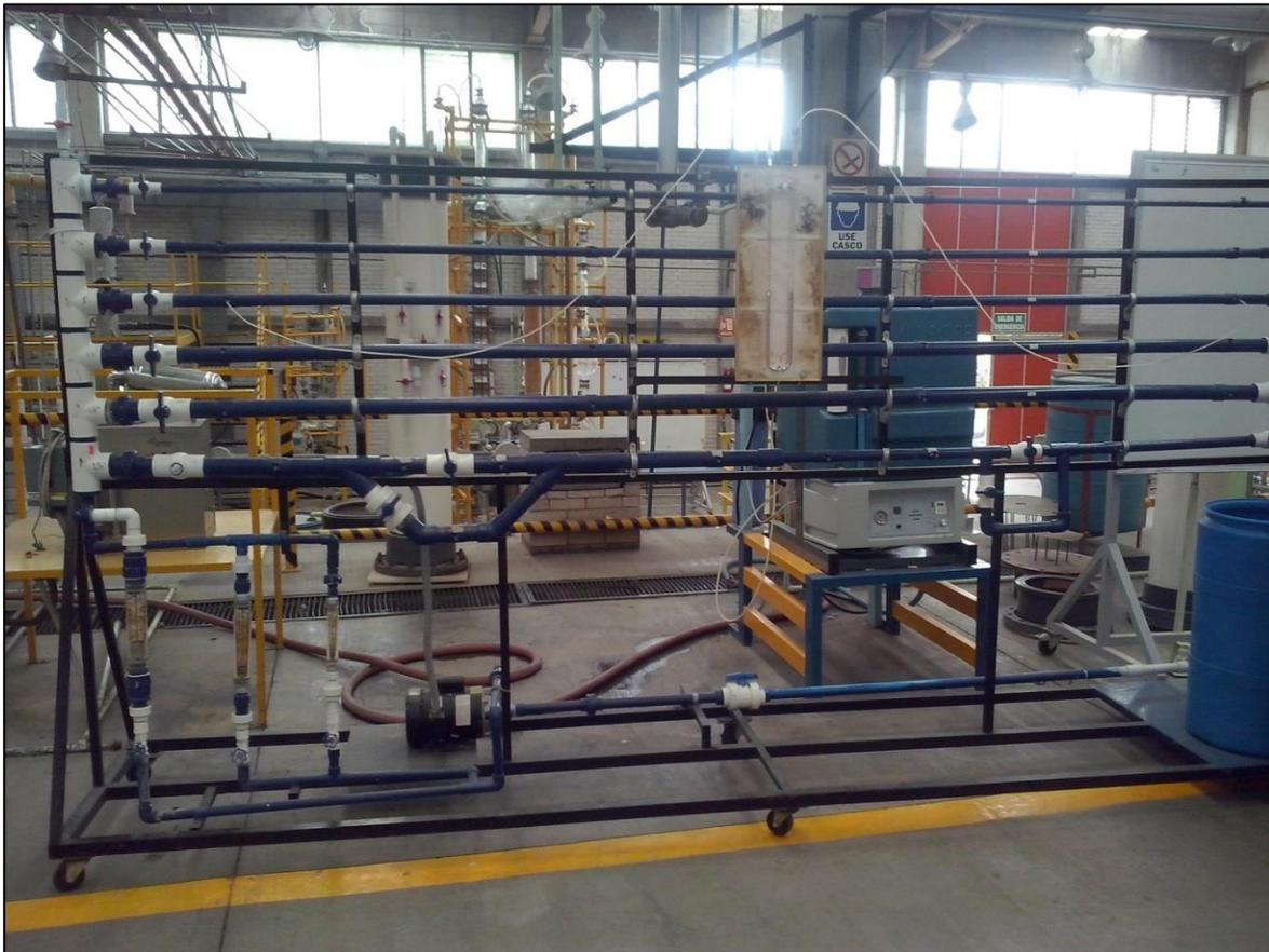
FIG. 4.13. Fotografía de Equipo de Flujo de Fluidos de P.V.C.
