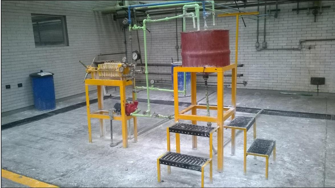
FIG. 4.2. Fotografía Filtro Prensa (Sistema Completo).
