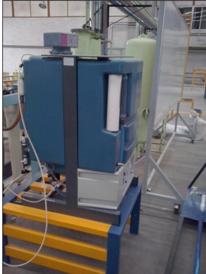
FIG. 4.14. Fotografía de Filtro de alta Pureza Millipore.
