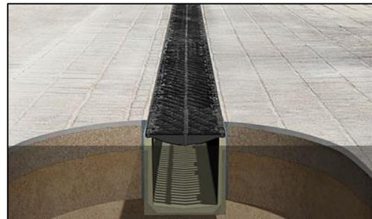
FIG. 2.23. Representación de la estructura del Drenaje en Planta Piloto y Modelo 3D
