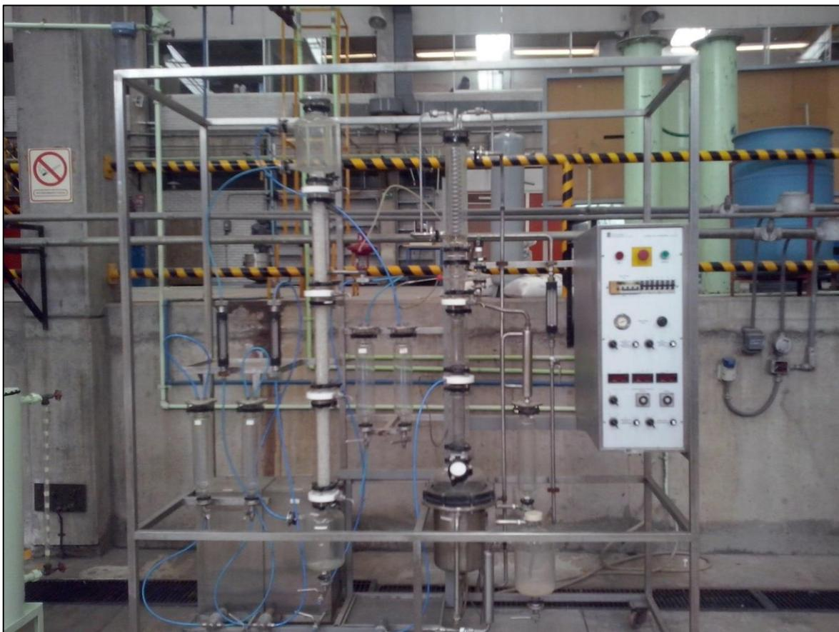
FIG. 4.23. Fotografía de Equipo de Extracción Líquido-Líquido.
