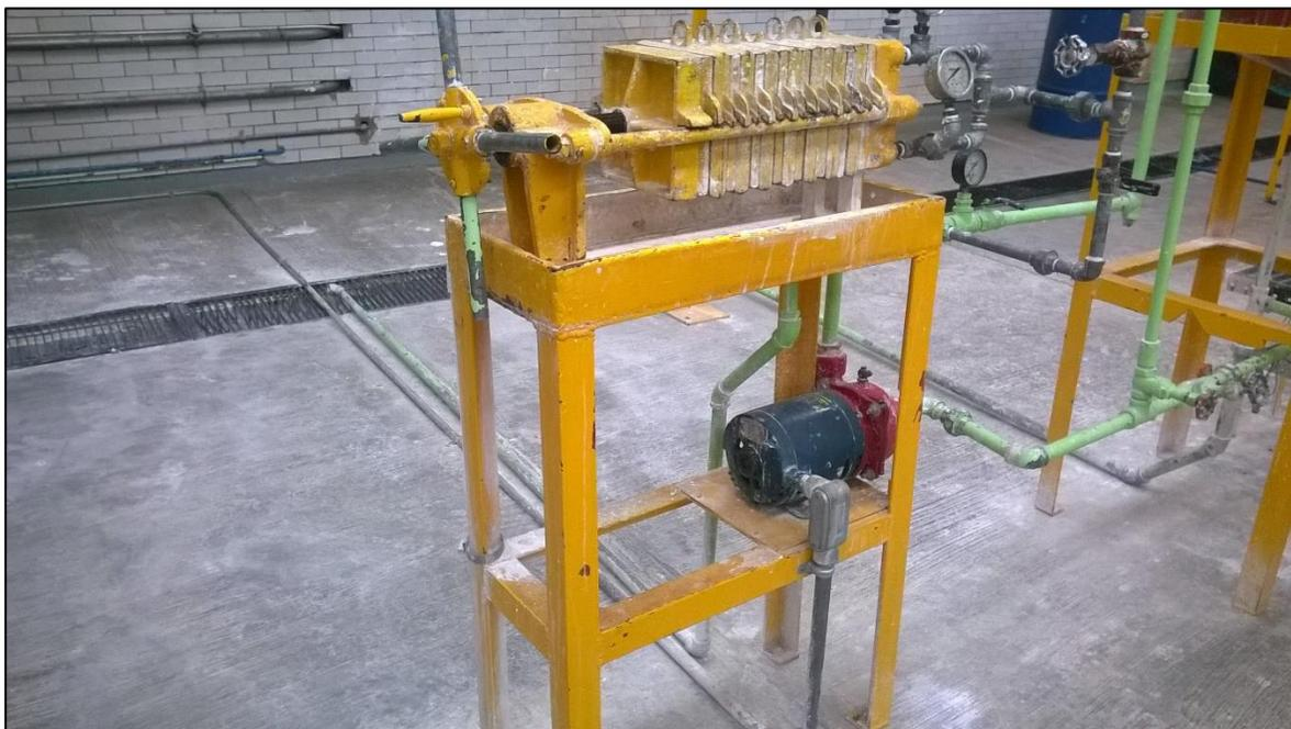
FIG. 4.3. Fotografía Filtro Prensa y Bomba Centrífuga.
