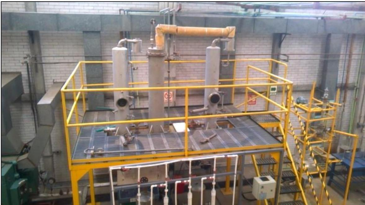
FIG. 4.32. Fotografía de Evaporador doble efecto.
