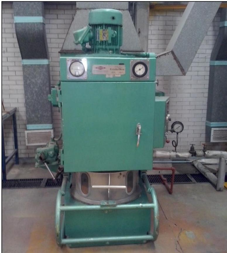
FIG. 4.33. Fotografía de Secador de Lecho fluidizado.
