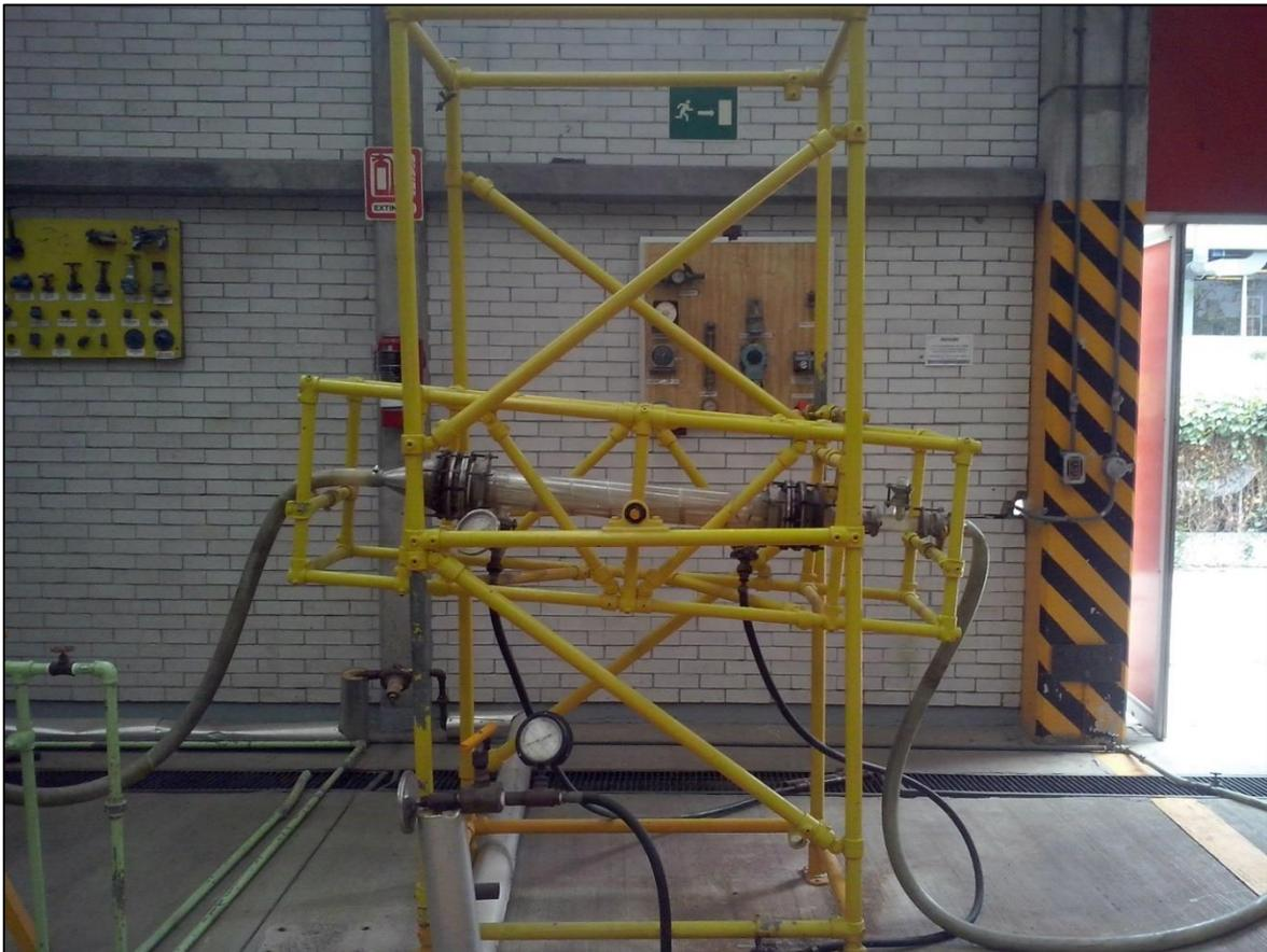
FIG. 4.22. Fotografía de Intercambiador de Calor de Tubos y Coraza de vidrio.
