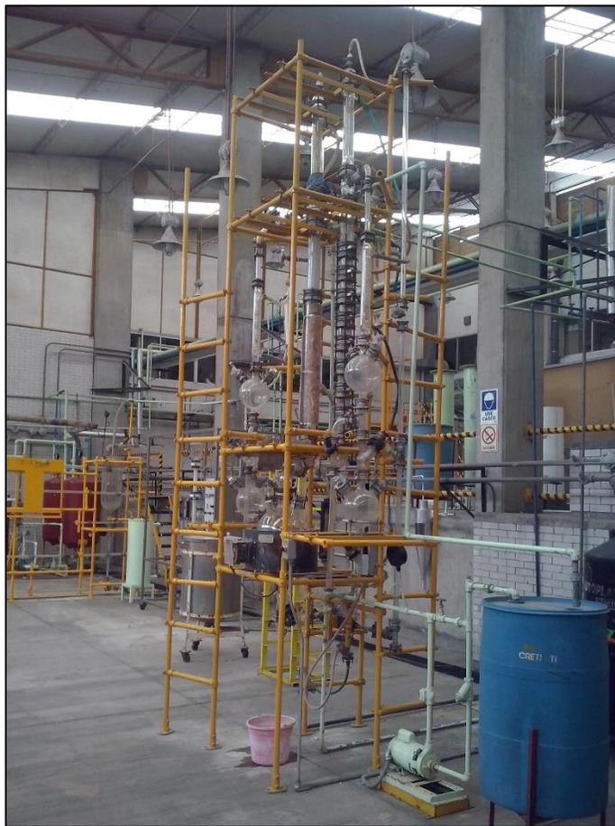
FIG. 4.24. Fotografía de Columna de Destilación de vidrio.
