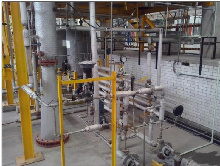
FIG. 4.35. Fotografía de Intercambiador de Tubos Concéntricos
