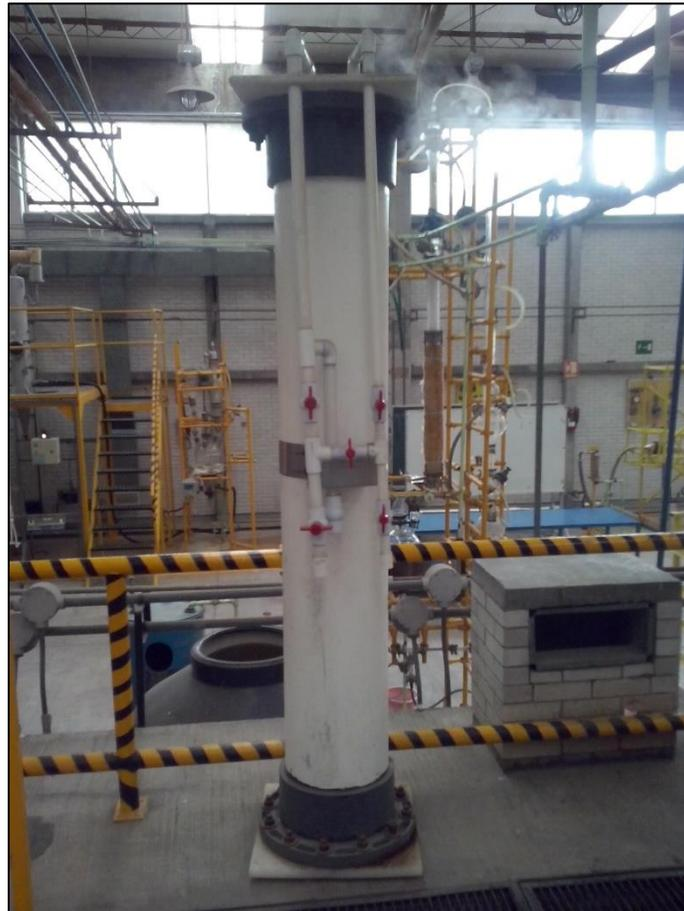
FIG. 4.15. Fotografía de Sistema de Filtrado de Alta Presión.
