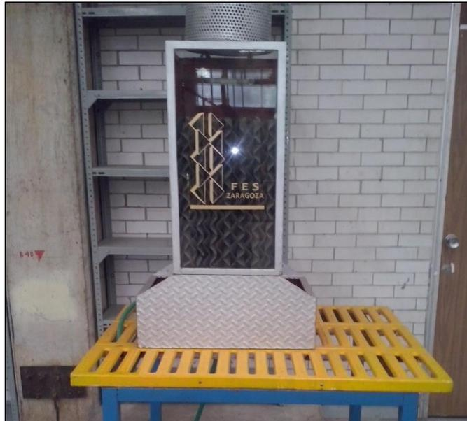
FIG. 4.8. Fotografía de Mini Torre de Enfriamiento.
