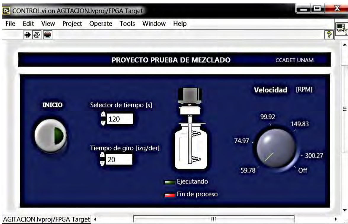
Figura 14. Interfaz gráfica de control de rotación del motor y tiempo en cada sentido.
