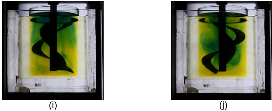
Figura 19. Ciclo de mezclado a 37.5 rpm inicial: (a) 28.6 min; (b) 28.8 min; (c) 35.8 min; (d) 36 min; (e) 36.1 min; (f) 36.2 min; (g) 45.8 min; (h) 46 min; (i) 48.8 min; (j) 49 min.
