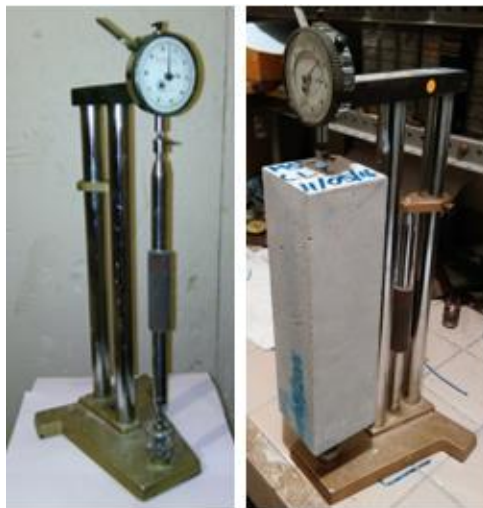
Figura 3.17 Comparador de longitudes utilizado y forma de medición.
