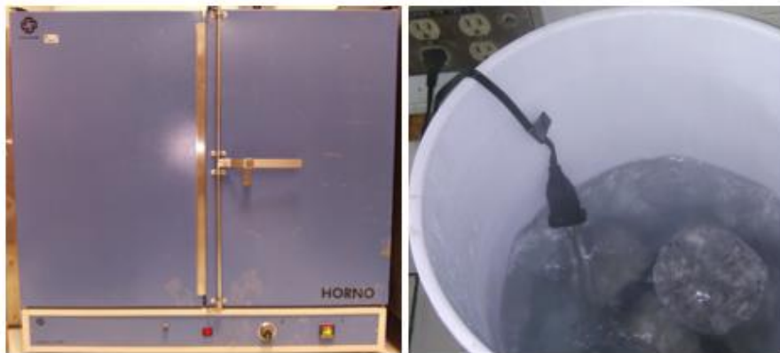
Figura 3.13 Horno utilizado para el secado de los especímenes y calentador de agua utilizado para la ebullición.
