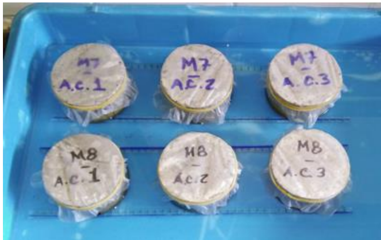
Figura 3.14 Configuración del dispositivo utilizado en el ensaye de absorción capilar
