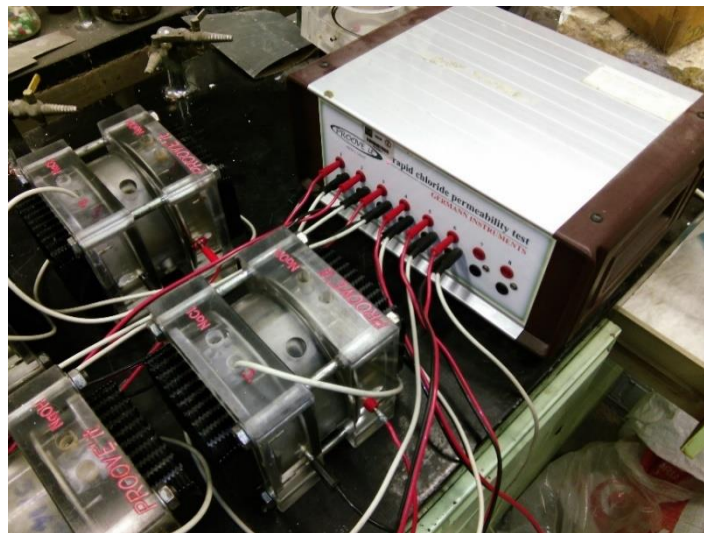
Figura 3.12 Equipo utilizado para la medición y el registro de la penetración de iones cloruros durante un ensaye.
