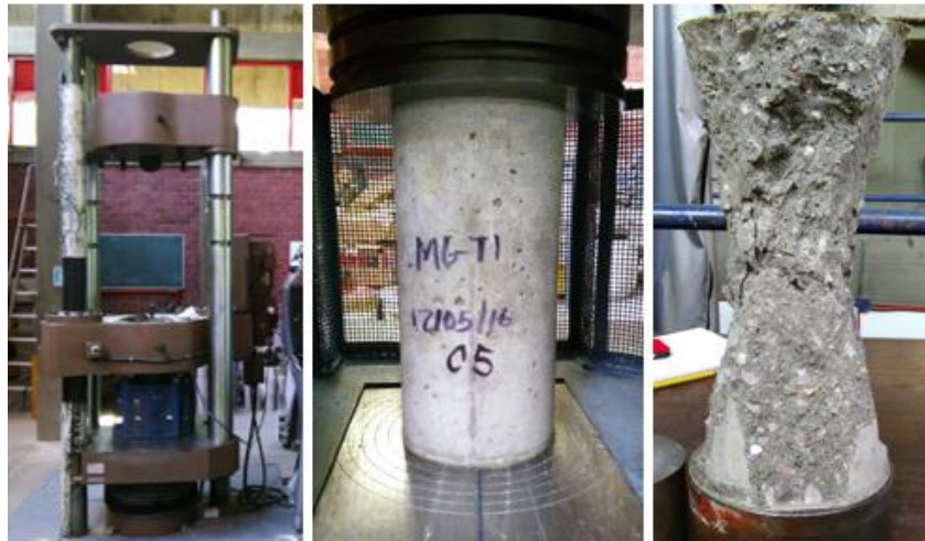
Figura 3.7 De izquierda a derecha: Prensa universal modelo SATEC, espécimen listo para ser ensayado, falla del espécimen después del ensaye.
