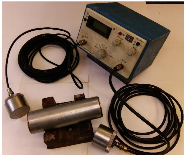
Figura 3.5 Equipo utilizado para la determinación de la VPU
