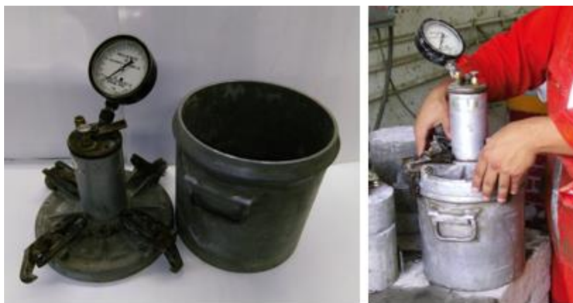
Figura 3.2 Equipo empleado para determinar el peso volumétrico y el contenido de aire de todas las mezclas
