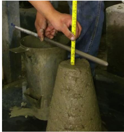
Figura 3.1 Ensayo de revenimiento realizado a una mezcla de concreto lanzado (mezcla M2).
