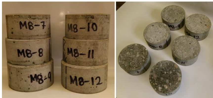
Figura 3.11 Ejemplo de especímenes utilizados para el ERPC, se muestran los especímenes de la mezcla M8 (500 kg/m 3 , 10% de ceniza volante y 4.9% de aire incluido) para su ensaye a 91 días.
