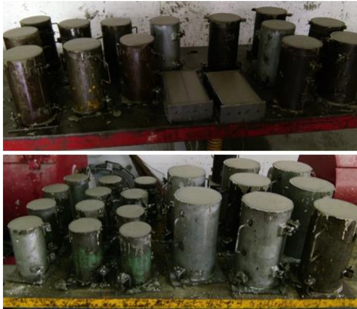
Figura 2.3 Especímenes fabricados de la mezcla “M8”, recién moldeados
