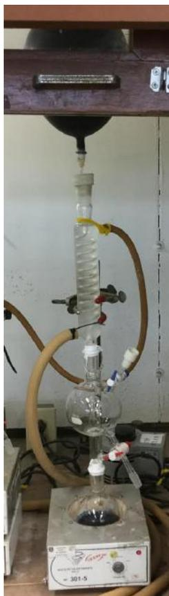
**Figura 3.4:** Montaje del sistema de secado de disolventes. La coloración azul indica que el disolvente se encuentra completamente seco y listo para destilar.
