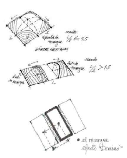
NORMALMENTE EL ÁNGULO DE INCLINACIÓN EN EL ARRANQUE ES DE 45GRADOS AL AVANZAR LA CONSTRUCCIÓN EL ÁNGULO SE INCREMENTA.
