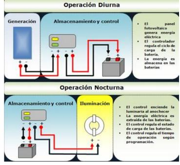
Operación de un sistema de alumbrado con sistema fotovoltaico
