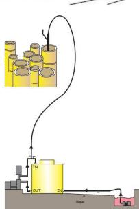
Se tiene que mover el bambú para la cuenca de concreto. Poniéndose de pie en posición vertical, se atan las cañas bien juntas para que no se pueden mover cuando se llenan con el bórax / Solución de ácido bórico. Las cañas se vuelven muy pesadas cuando están llenas.
