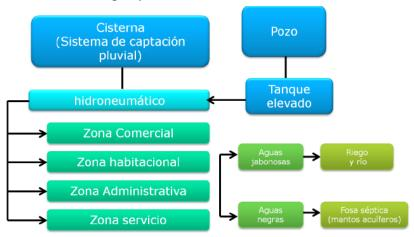
Una red de distribución principal de agua potable fría proveerán de agua a los lavabos, fregaderos y duchas, y un ramal alimentara a los calentadores solares u caldera para proveer de agua caliente; se utilizará el agua pluvial, para jardines y suministro de las cisternas de servicio; la
