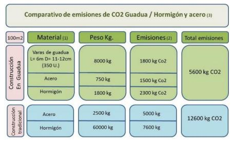
Materiales básicos para estructura de una edificación de 100 m2 de construcción.
