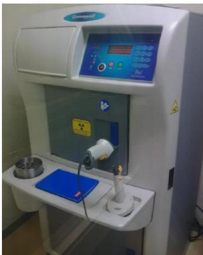
**Figura 3.3 Irradiador Gamacell-3000 con fuentes de  $^{137}\text{Cs}$ , emisor gamma. Las muestras se irradiaron en la cámara interior donde se observa el símbolo de presencia de radiación.**
