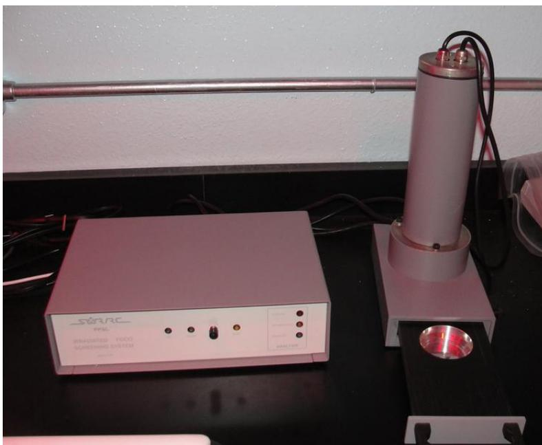
Figura 3.5: Equipo SUERRC PPSL con un arreglo de diodos infrarrojos.
