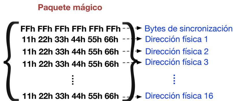
**Figura 3.9.** Estructura de un paquete mágico. Se muestran los seis bytes FFh seguido de 16 repeticiones de la dirección física.
