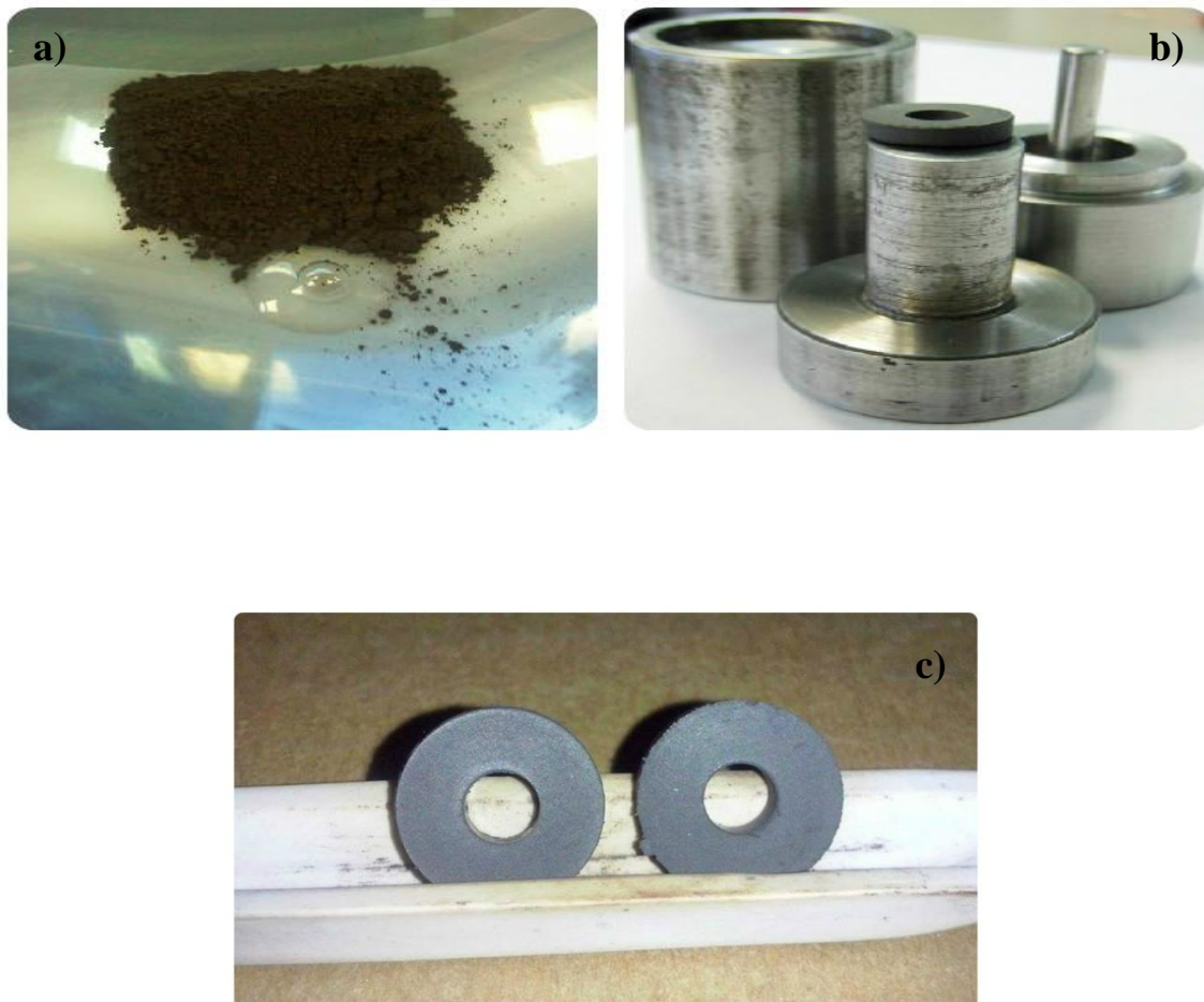
Figura 3. 6. a) Mezcla de ferrita en polvo con PVA. b) Formación en toroide con un dado metálico. c) Toroides obtenidos al final del sinterizado.
