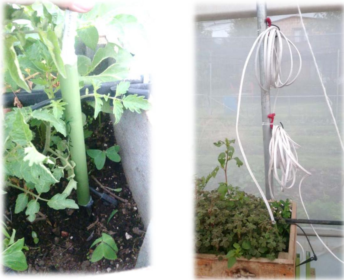
*Ilustración 22: Sensores de humedad de superficie los cuales se entierran en la tierra (izquierda), y están equipados con metros extra de cable que permiten moverlos entre macetas (derecha).*
