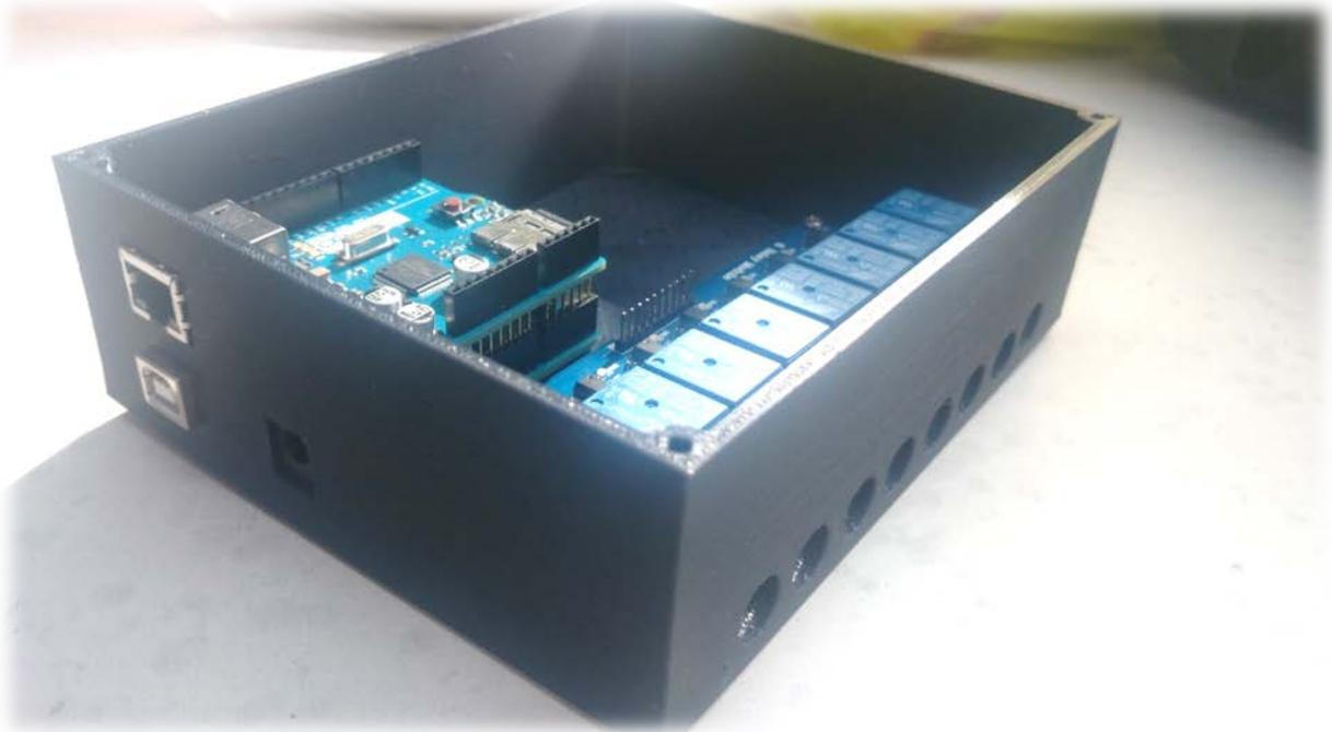
*Ilustración 19: La caja contenedora fue impresa en 3D, por lo que está diseñada para acomodar el microcontrolador y la distribución de los sensores.*
