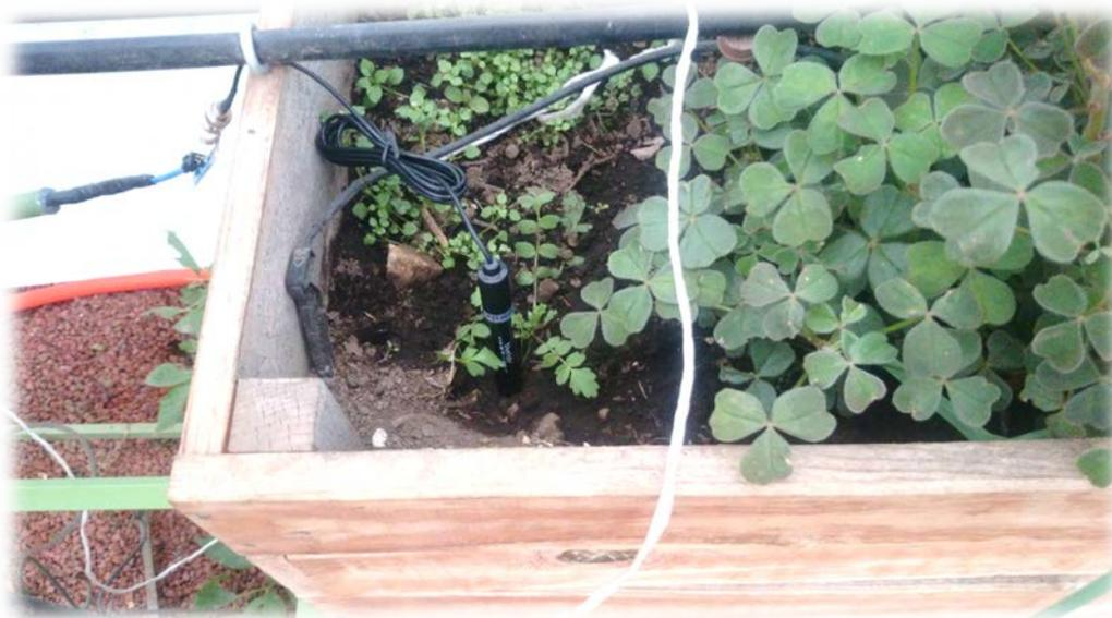
*Ilustración 23: Sensor de pH de suelo, el cual se entierra en la tierra para obtener lecturas.*
