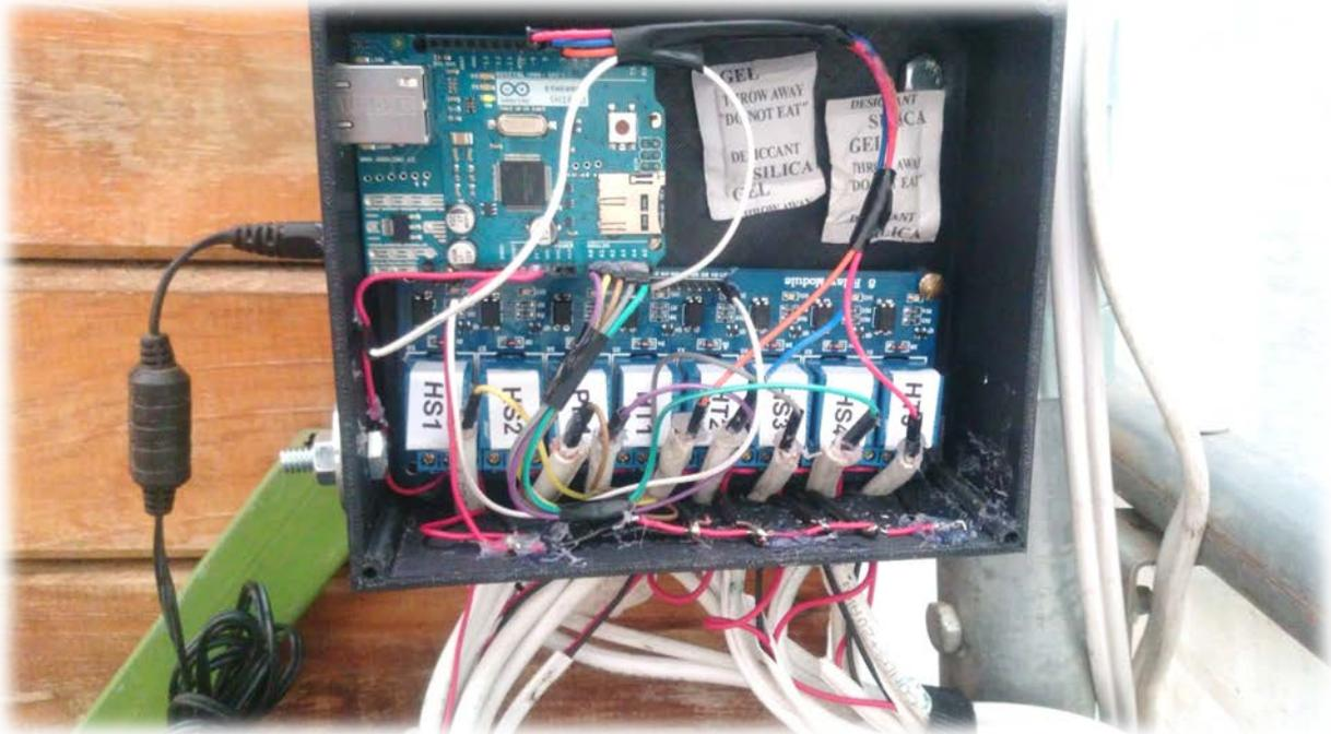
*Ilustración 20: Organización final del cableado en el microcontrolador.*
