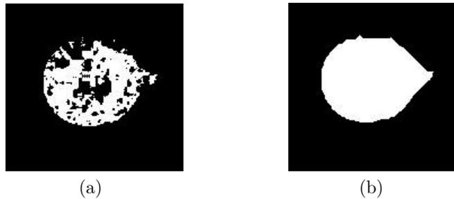
Figura 3.9: (a) Se muestra la imagen binaria sin filtros, (b) muestra la imagen obtenida aplicando filtros de forma
