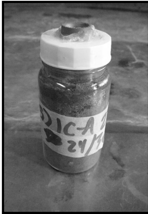
Figura 13. Frasco con suelo y tapa modificada para la extracción del gas.
