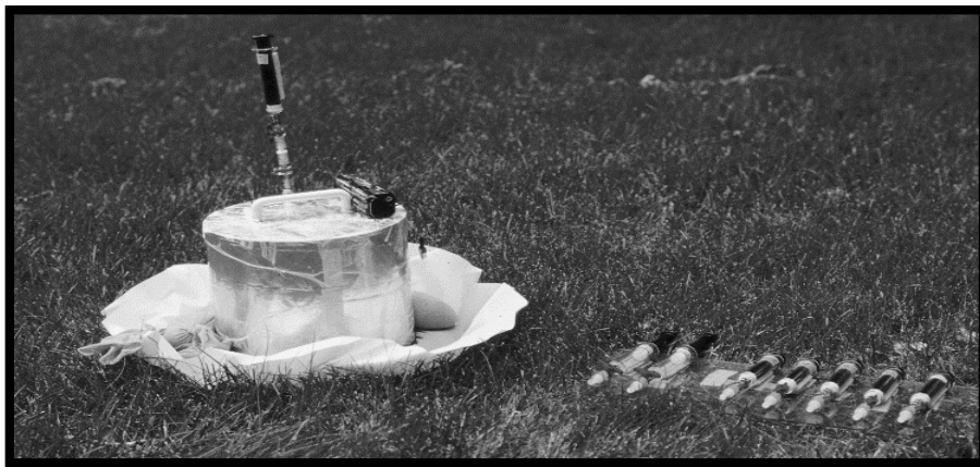
Figura 7. Cámara dinámica cerrada. Fuente: USGS, 2012.
