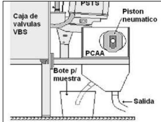
Figura 6.2.1. Imagen de la toma de muestra del cortador.
