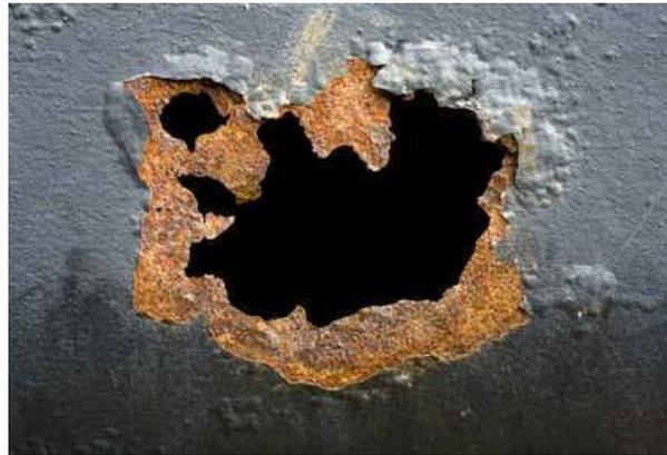
**Figura 1.5** Corrosión por picadura en acero en medio marino[1]
