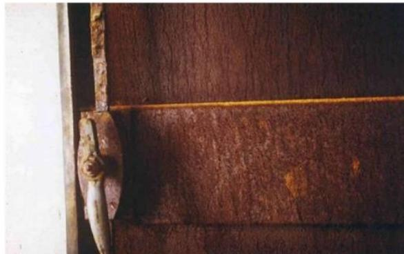
Figura 1.1 Corrosión uniforme [1]
