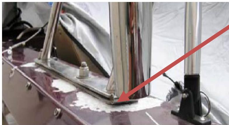
Figura 1.4 Corrosión por crevice entre los metales [3]
