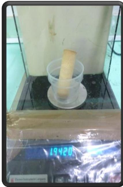
**Figura 17.** Pesaje de la muestra antes y después de la extracción de grasa.
