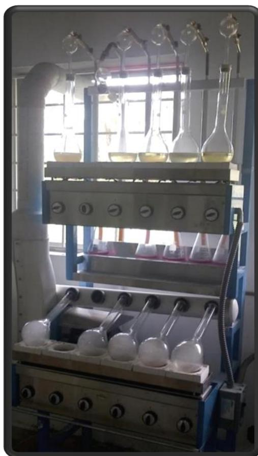
**Figura 14.** Aparato de Kjeldahl, en proceso de digestión (abajo) y destilación (arriba) de las muestras.
