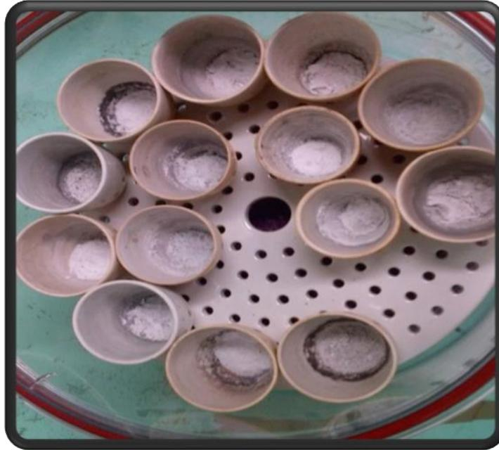
**Figura 19** Crisoles con muestras de cenizas.
