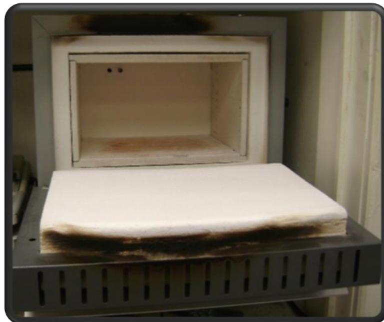
**Figura 18.** Mufla para la obtención de las muestras de cenizas.
