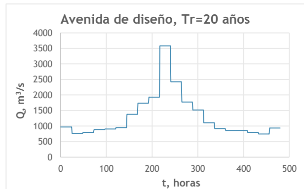
Figura 4.18. Forma del hidrograma horario con base en los gastos medios diarios, Tr=20 años
