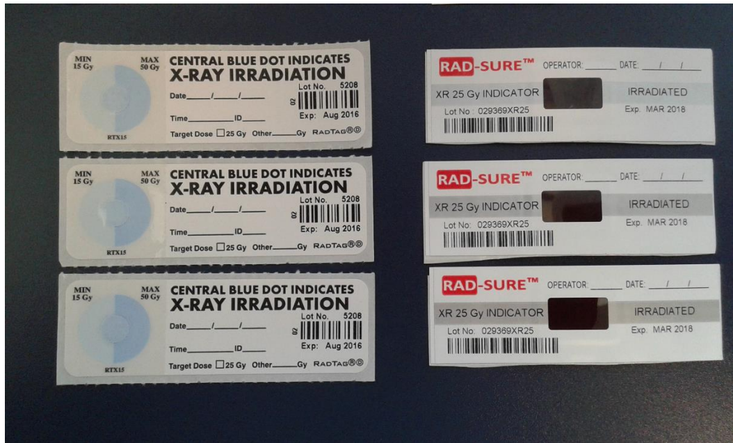
Figura 9. Tiras indicadoras post irradiación a dosis de 25 Gy. Izquierda tiras indicadoras Rad Tag®, derecha tiras indicadoras RAD SURE™.
