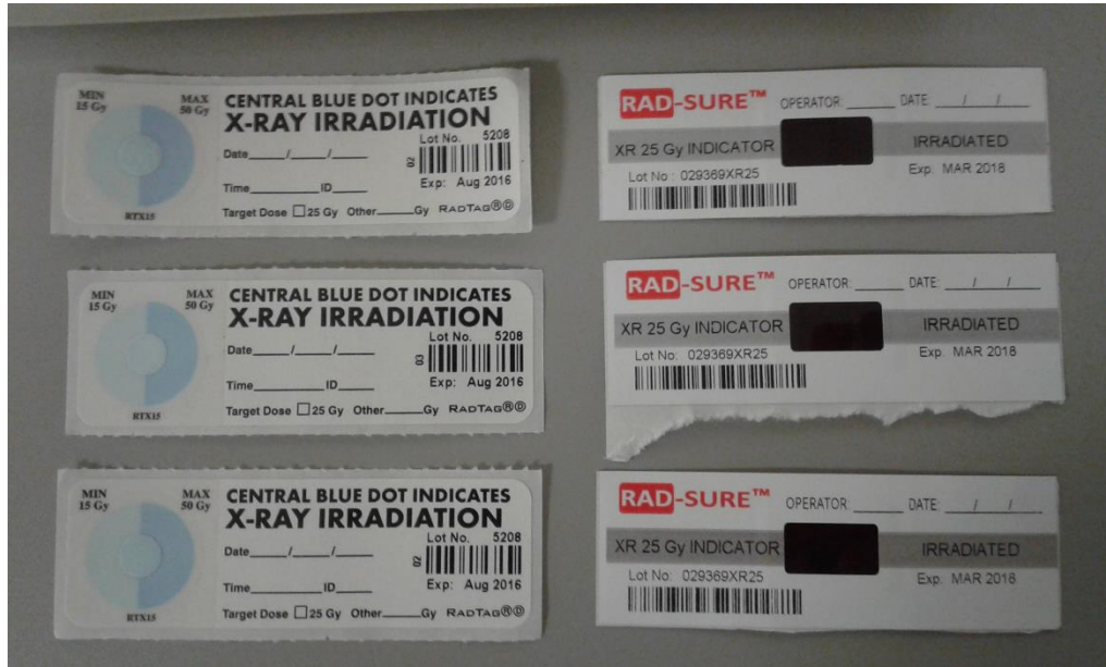
Figura 8. Tiras indicadoras post irradiación a dosis de 15 Gy. Izquierda tiras indicadoras Rad Tag®, derecha tiras indicadoras RAD SURE™.
