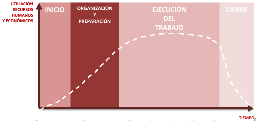
Gráfico 2.1. Recursos humanos y económicos durante el ciclo de vida de un proyecto. 2
