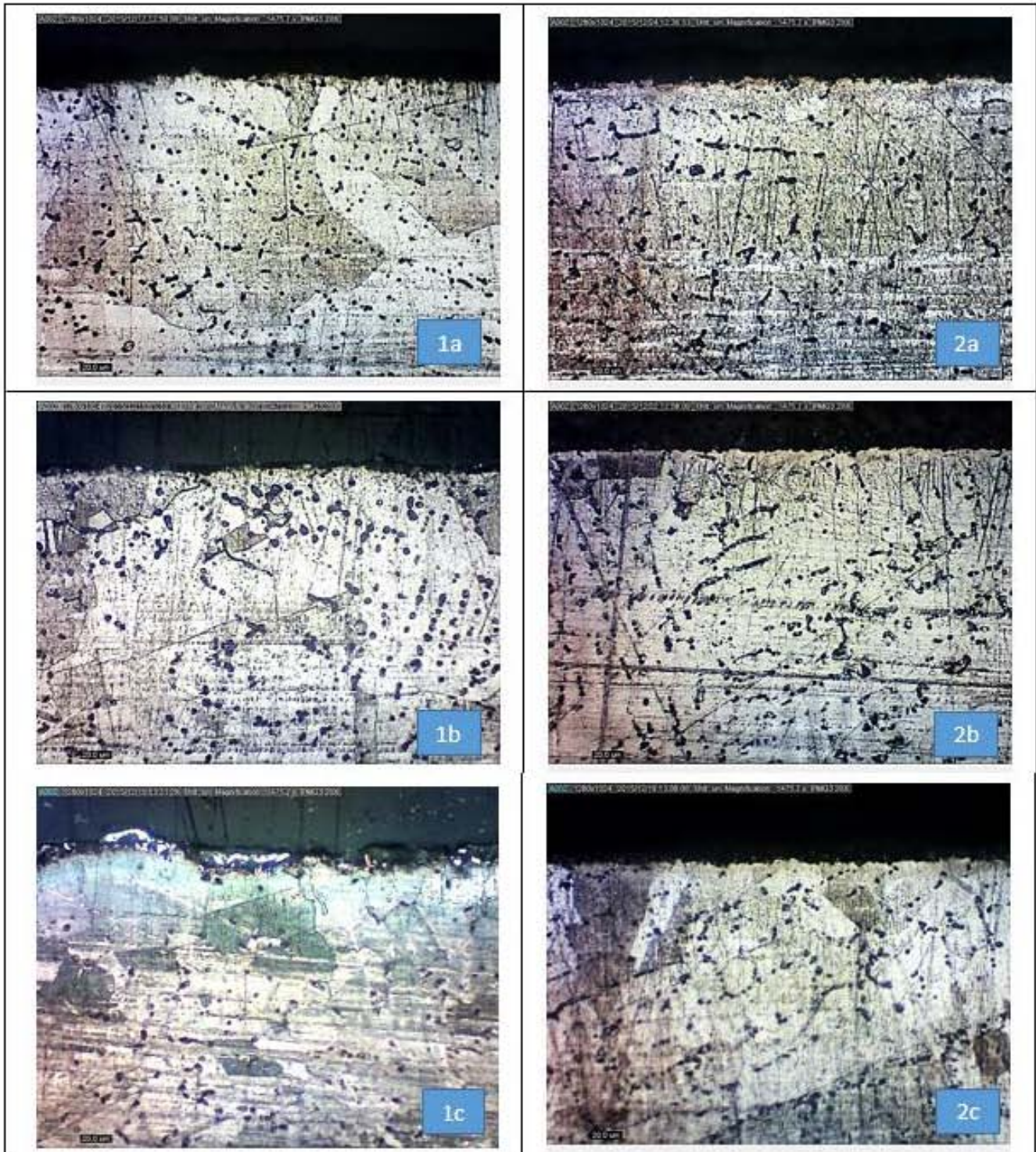
Figura 32. Borde de la probeta Cu-Ag 5%. 200x. (1a) 770°C 1.5h. (1b) 770°C 3.0h. (1c) 770°C 4.5h. (2a) 670°C 1.5h. (2b) 670°C 3.0h. (2c) 670°C 4.5h.
