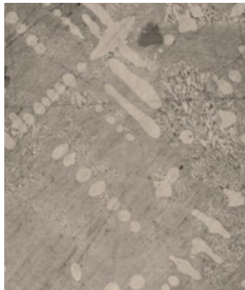
Figura 13. Microestructura de la aleación hipoeutética Cu 50% - Ag 50% [22].
