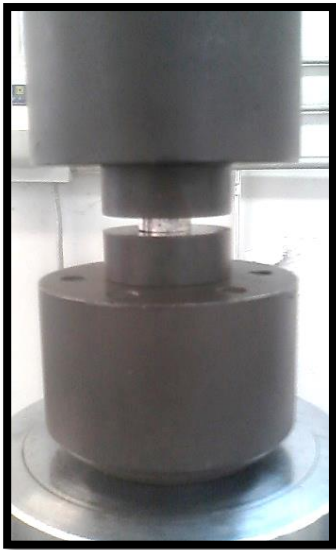
Figura 20. Compresión de las probetas en un 25% en la Máquina MTS.
