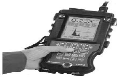
Figura 3. Medidor ultrasónico DMS-2. Fuente: DMS 2E, DMS 2, DMS 2TC - Datos técnicos y accesorios
