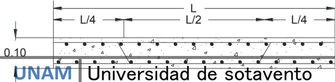
DETALLE DE LOSA DE CONCRETO
