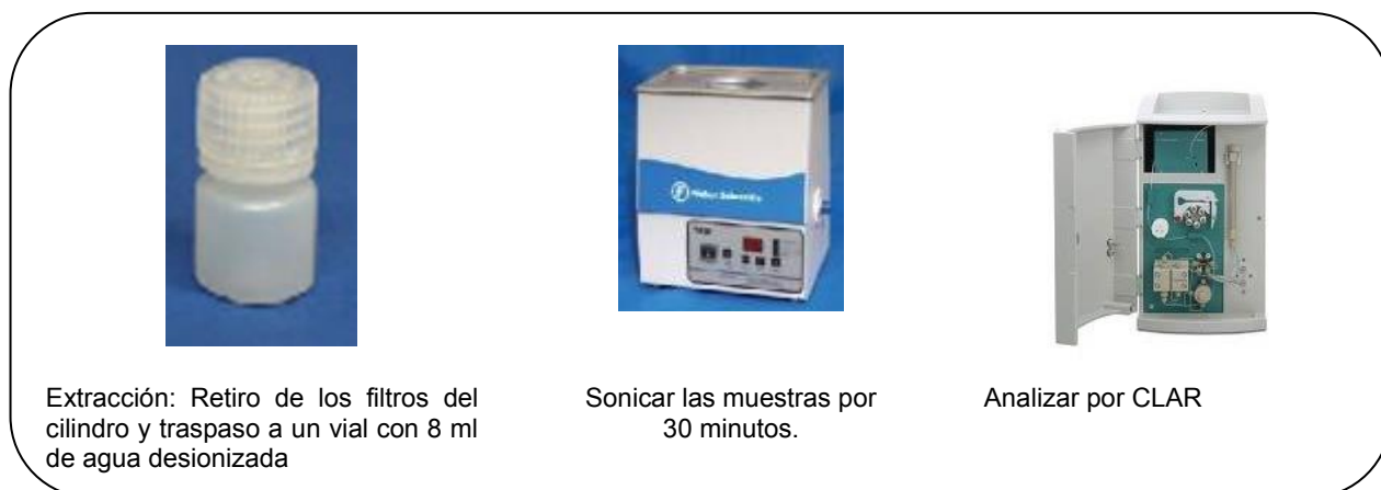
Fig. 2.9 Extracción y cuantificación del analito absorbido por el captador
