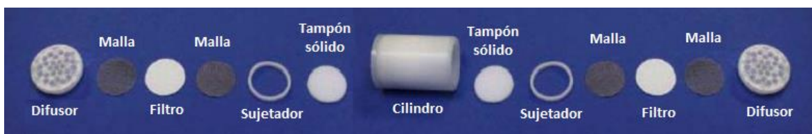
Fig. 2.7 Ensamble del captador Ogawa
