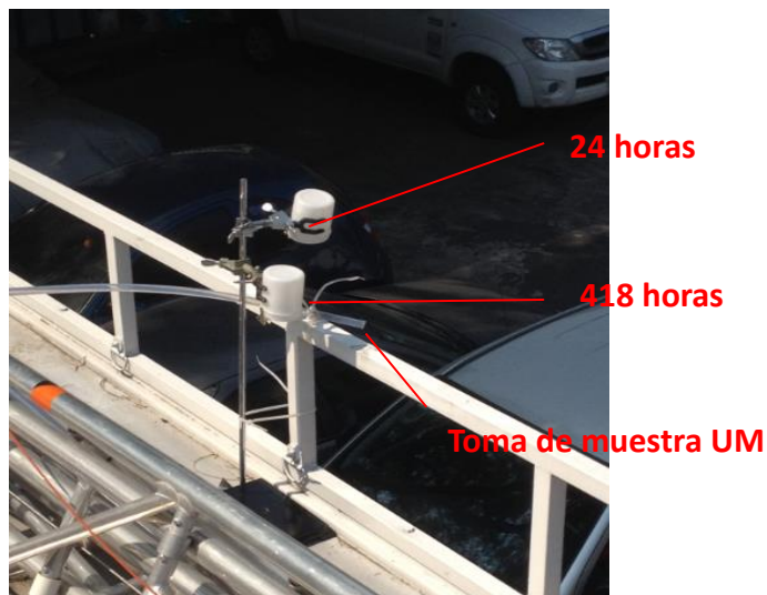
Fig. 1 ubicación de los captadores pasivos Ogawa y la toma de muestra de la unidad móvil
