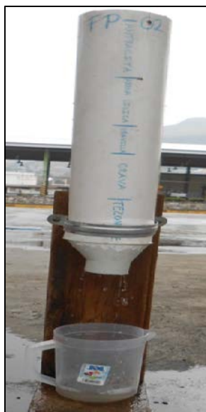
Figura 3.10 Filtro piloto Arreglo Tezontle-Grava-Gravilla-Arena Sílica-Antracita
