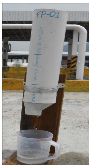
Figura 3.9 Filtro piloto Arreglo Tezontle-Grava-Gravilla-Arena Sílica
