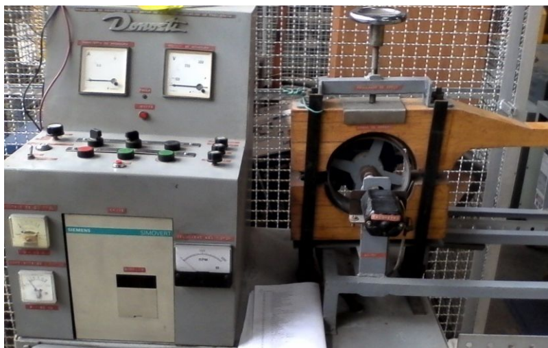
Fig. 5.11) Variador acoplado a motor de inducción trifásico y freno de Prony.
