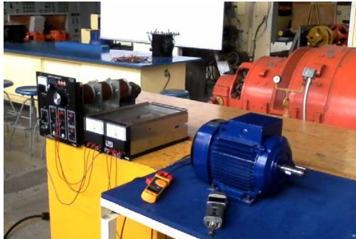
Fig. 3.5) Montaje del equipo sin el tren de engranes..
