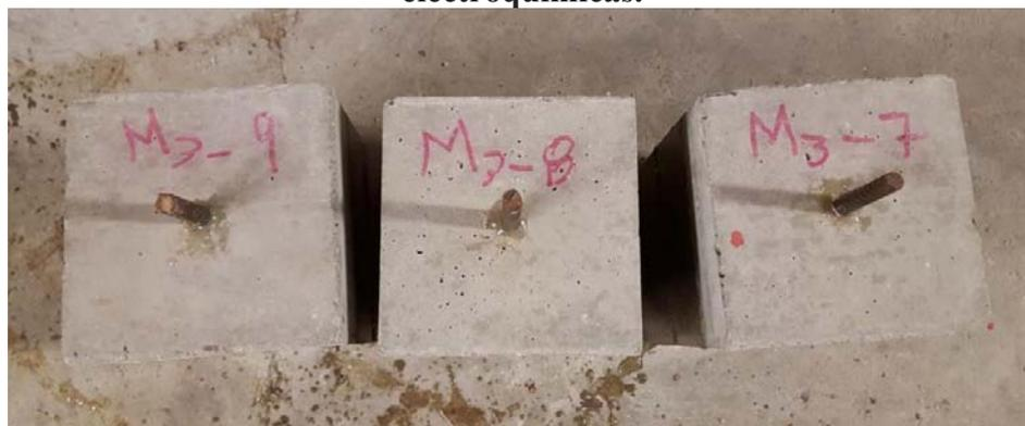
**Imagen 4, especímenes del concreto MT4, sumergidas en la solución salina de 15000 ppm de iones Cl<sup>-</sup>.**
