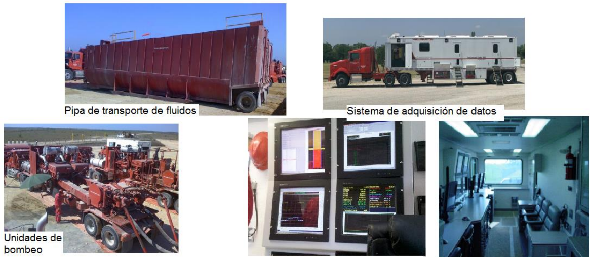
Fig. 5.18. Equipo necesario para un minifrac.
