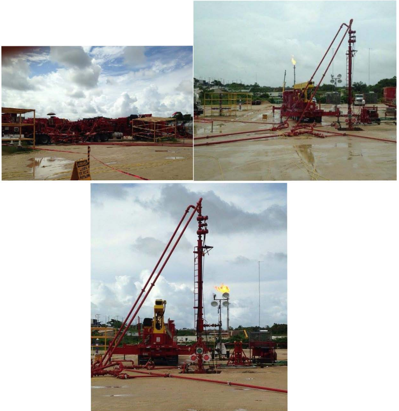
Fig. 5.19. Unidades de bombeo, pozos vecinos y pozo Jun 1 con equipo para prueba de minfrac.
