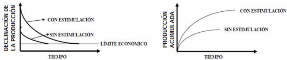
Fig. 3.5 Gráficas comparativas entre un pozo con estimulación y sin estimulación en yacimientos de baja permeabilidad (Adaptada de Islas Silva 24 ).
