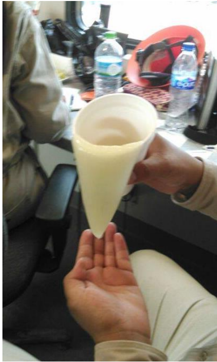
Fig. 5.20. Gel de fractura activado con el que se realizó la prueba de minifrac en el pozo Jun 1.
