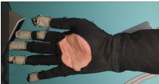
Figura 4.31. Guante de datos para neuro-rehabilitación. Autoría propia.
