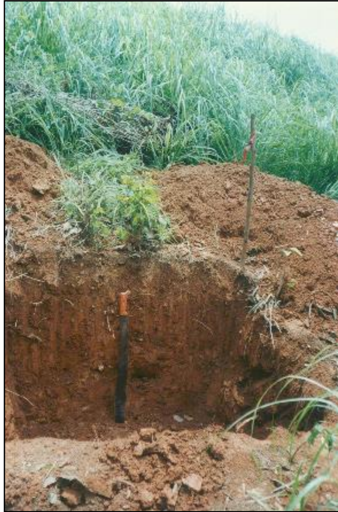
Fotografía 3.6 Material arcilloso encontrado en uno de los pozos ejecutados en el banco El Zopilote.
