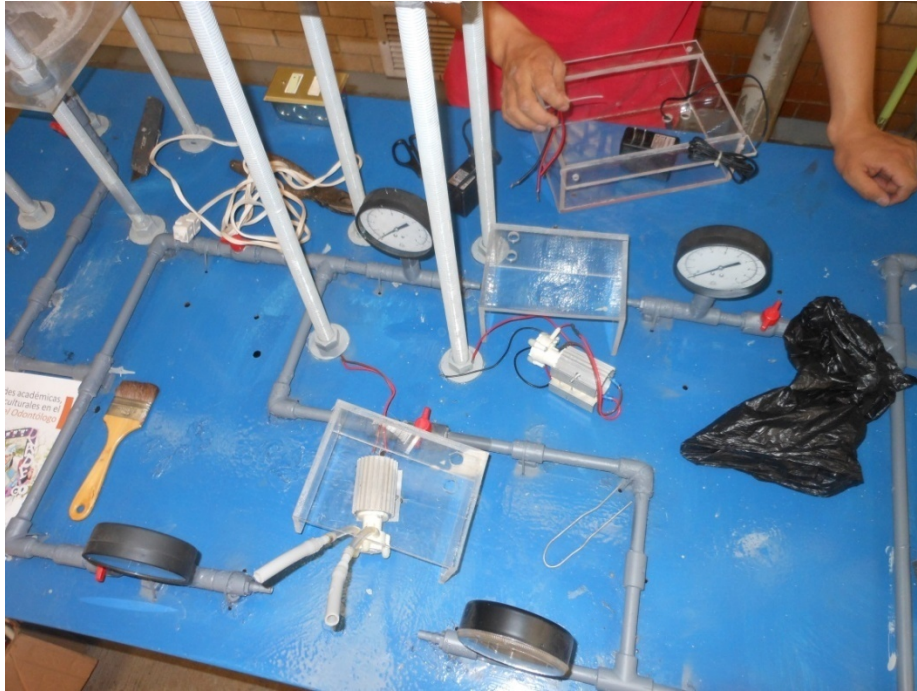
Figura 4.6 Se conectan las bombas a la fuente eléctrica
