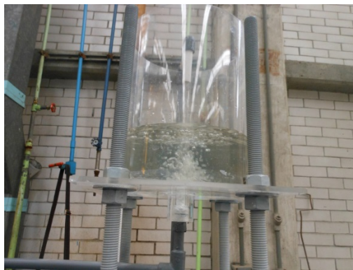
Figura 4.28 Taques instalados en el sistema hidráulico
