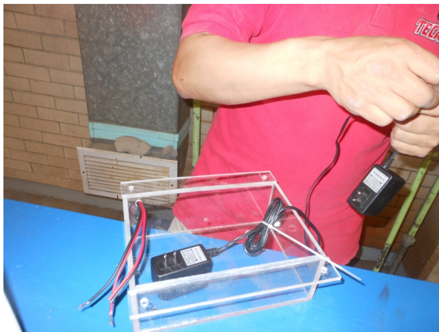
Figura 4.5 Instalando los eliminadores de luz
