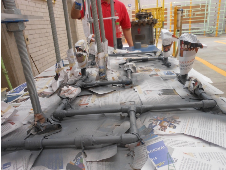
Figura 4.10 Se pintan los tubos con pintura de aerosol color gris
