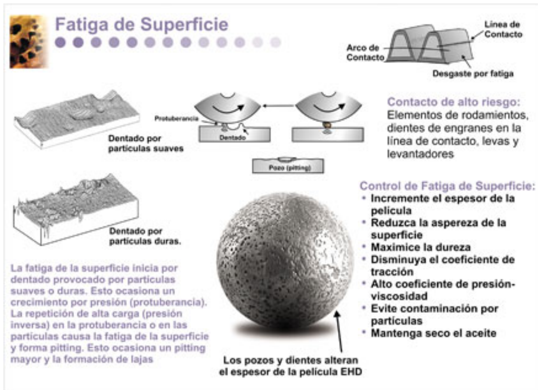
Figura 3.5 Fatiga en sub-superficies en bombas de engranajes internos.
