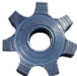
Figura 3.3 Engrane con daño de corrosión.
