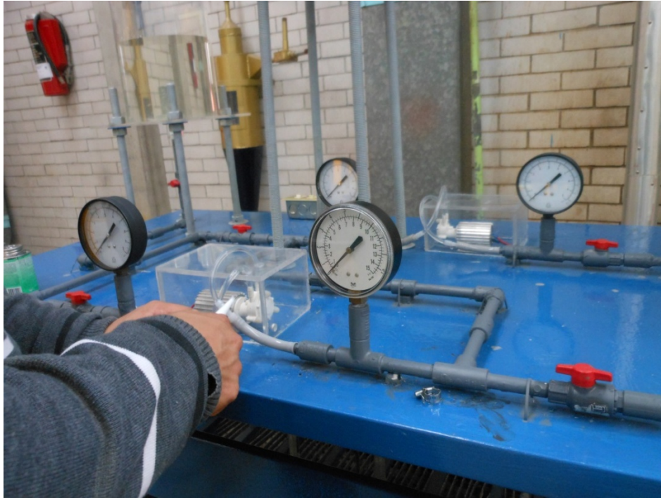
Figura 4.14 Las bombas se les colocaron unas adaptaciones con tubería de plástico
