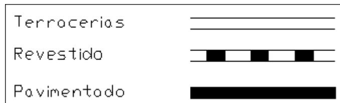
Imagen 1.1.- Clasificación de carreteras por transitabilidad.
