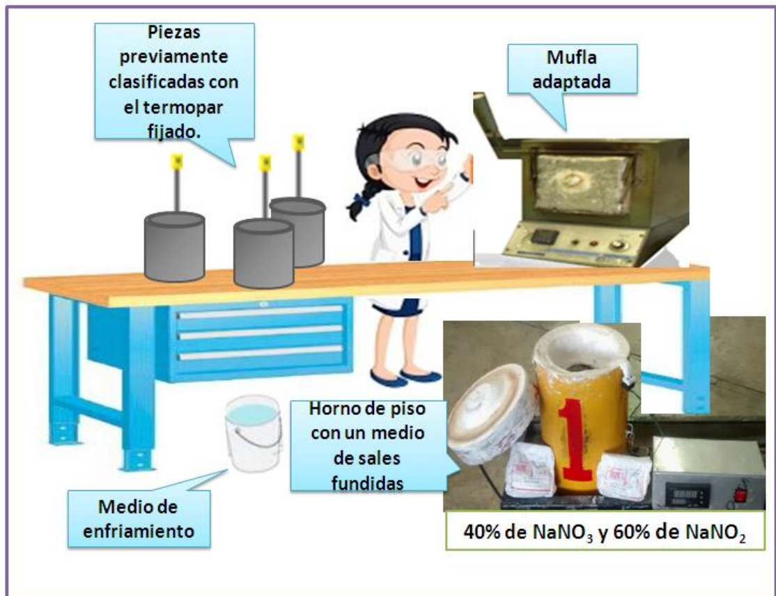
Figura 38. Equipo para calentar, enfriar y realizar el tratamiento de austemperizado.
