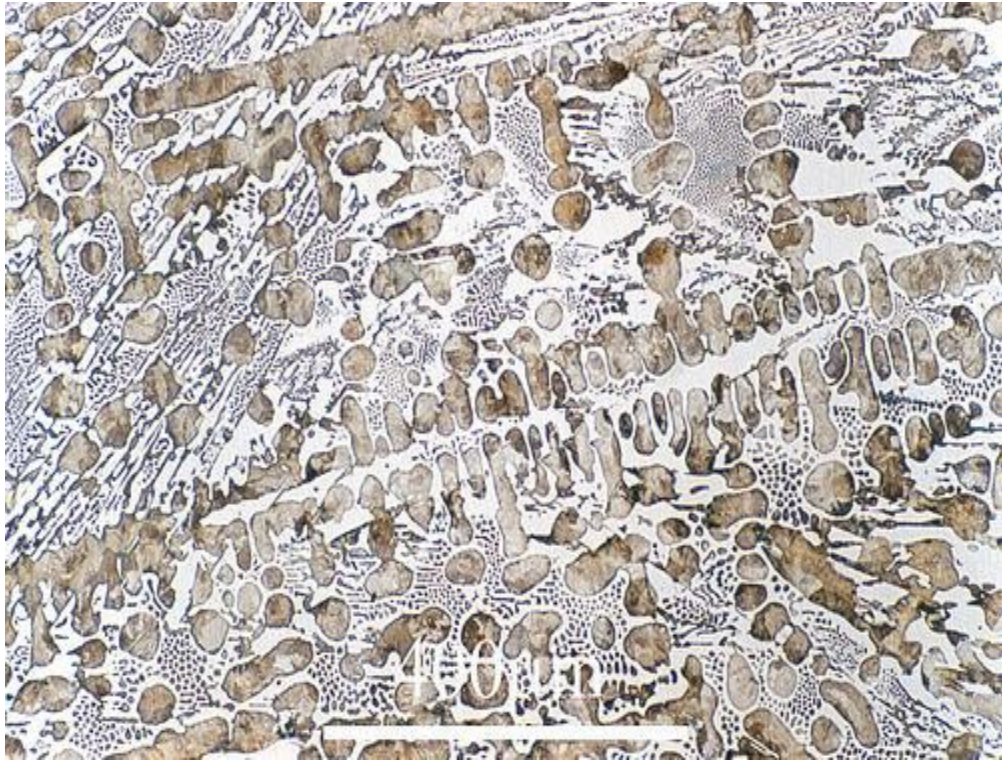
Figura 1. Fundición blanca hipoeutéctica. Se observa una microestructura de Perlita libre (negra) y pseudoledeburita (perlita sobre un fondo blanco de Fe_3C ). [11]
