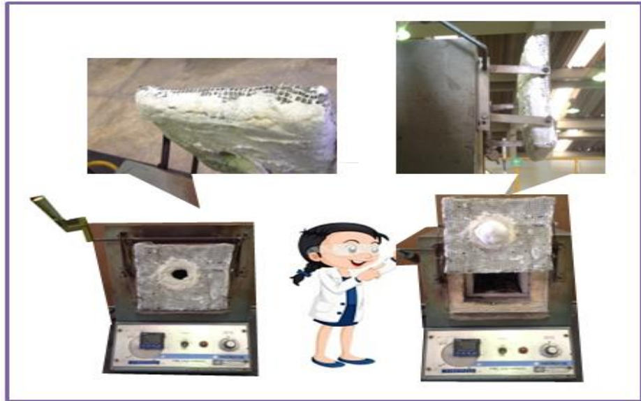
Figura 35. Modificaciones hechas a la mufla para realizar los tratamientos térmicos de la experimentación.
