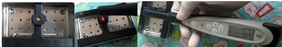
Imagen 12. Calibración del DIAGNOdent pen®
