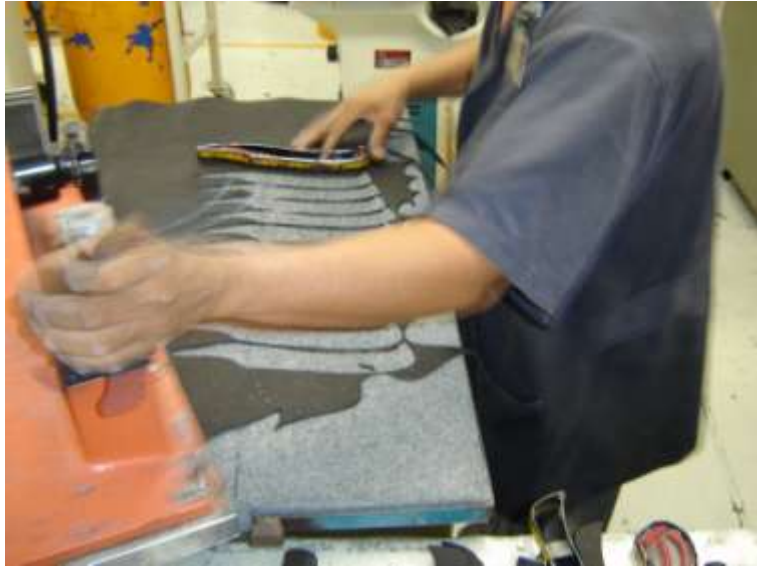
Figura 11 Corte de piel con suajes
