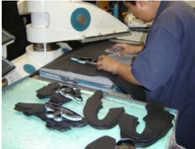
Figura 10 Corte de Piel con suajes
