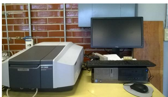
Figura 19 Espectrofotómetro UV-Vis utilizado para determinar la concentración de cada muestra.
