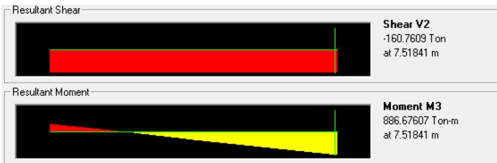
Fig.2.55 (Diagrama de momento y cortante de subestructura)
