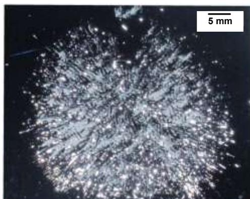
Figura 4.9 Patrón de autodestrucción de las películas de Mo por esfuerzo residual.
