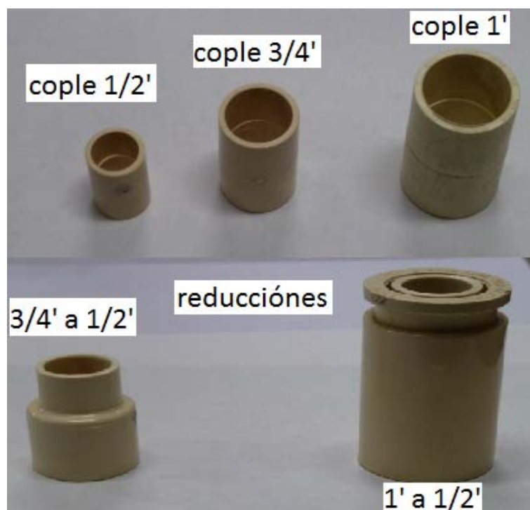
Figura 2.14. Coples y reducciones utilizados para armar los circuitos
