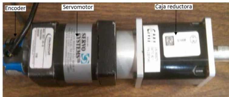
Figura 2.1. Acoplamiento del encoder (DA15-1000-5VLD), servomotor brushless (serie E-3622) y cabeza reductora (23EP040)
