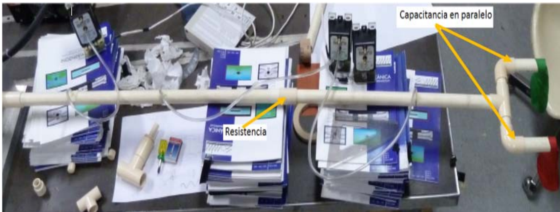
Figura 2.24. Circuito resistivo, con capacitancia en paralelo
