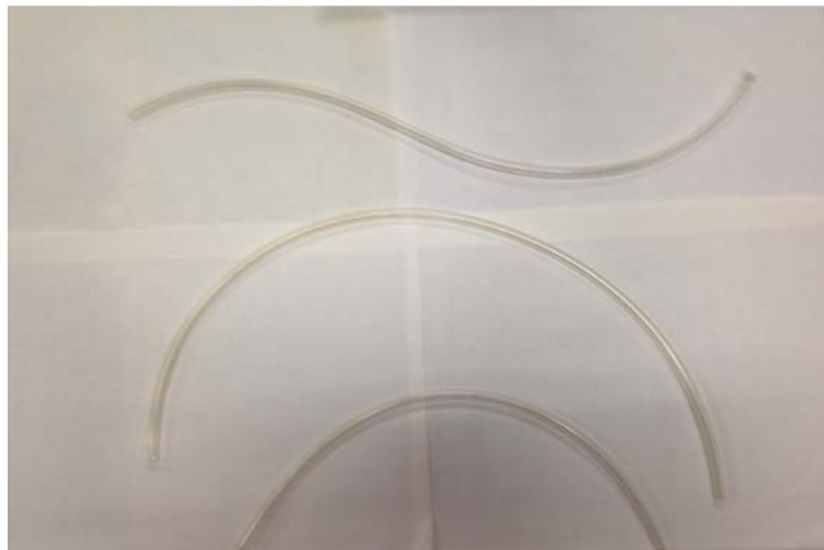
Figura 2.13. Mangueras rígidas para la toma de presión
