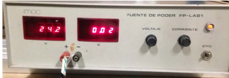
Figura 2.10. Fuente de voltaje para la alimentación de los sensores de presión SETRA
