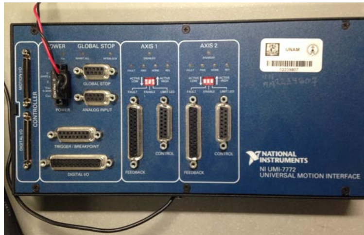
Figura 2.5. Interface universal de movimiento UMI-7772
