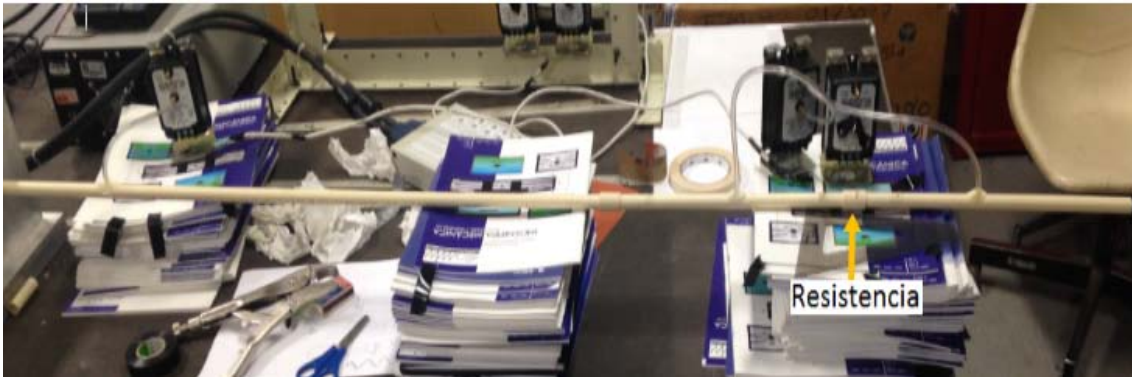
Figura 2.26. Circuito resistivo, con obstrucción mediante un orificio
